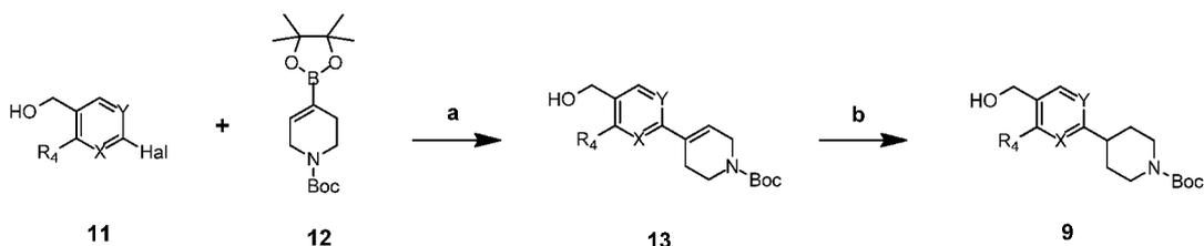
Условия: а) Pd(PPh<sub>3</sub>)<sub>4</sub>, Na<sub>2</sub>CO<sub>3</sub>, DME, H<sub>2</sub>O, 100°С; б) H<sub>2</sub>, PtO<sub>2</sub>, EtOAc
