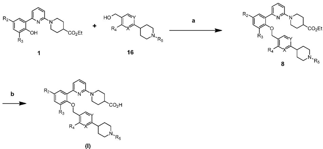
Условия: а)  $\text{DEAD}$ ,  $\text{PPh}_3$ ,  $\text{THF}$ ,  $0^\circ\text{C}$  до комнатной температуры;
