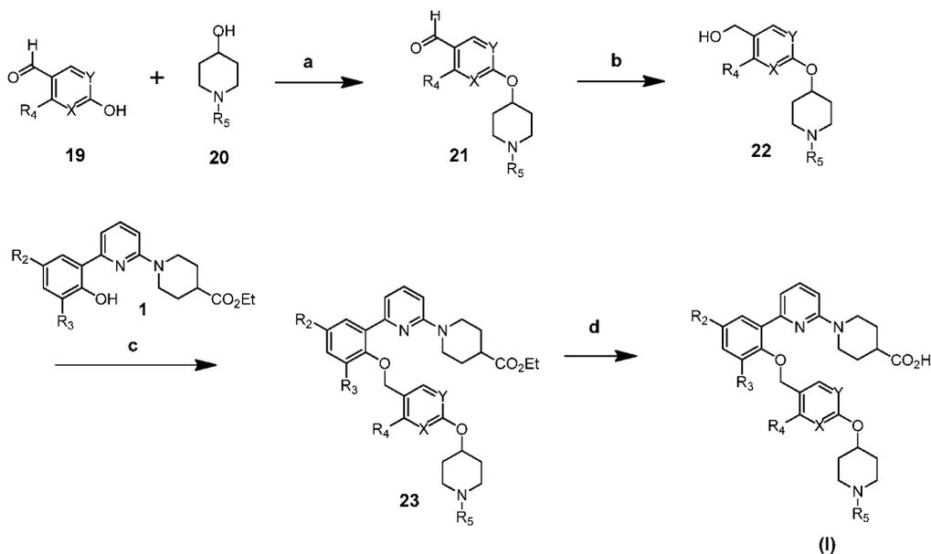
Условия: а) ) DEAD, PPh<sub>3</sub>, THF, от 0°С до комнатной температуры; б) NaBH<sub>4</sub>, EtOH, 0°С до комнатной температуры; с) DEAD, PPh<sub>3</sub>, THF, от 0°С до комнатной температуры; д) NaOH или LiOH, H<sub>2</sub>O, ROH, КТ.
