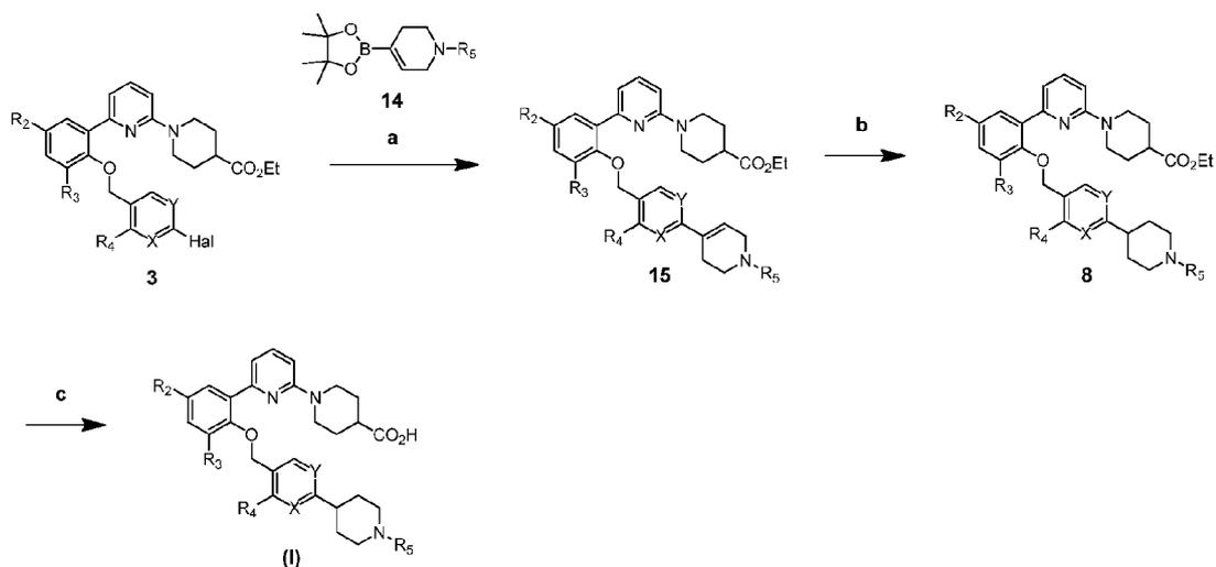
Условия: а)  $\text{Pd}(\text{PPh}_3)_4$ ,  $\text{Na}_2\text{CO}_3$ ,  $\text{DME}/\text{H}_2\text{O}$ ,  $100^\circ\text{C}$ ; б)  $\text{H}_2$ ,  $\text{PtO}_2$ ,  $\text{EtOAc}$ ; в)  $\text{NaOH}$  или  $\text{LiOH}$ ,  $\text{H}_2\text{O}$ ,  $\text{ROH}$ , комнатная температура.
