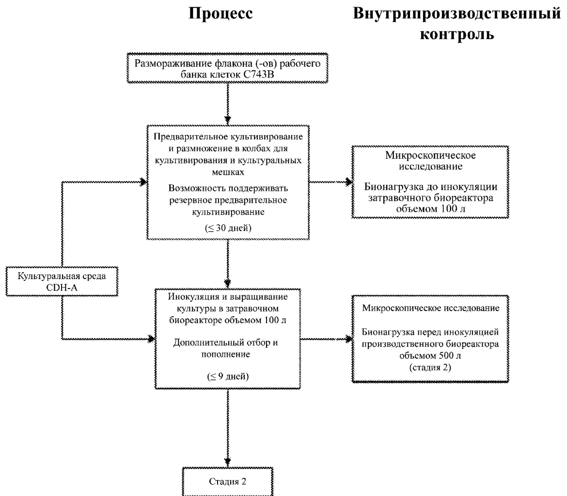
Стадия 1. Схема технологического процесса для предварительного культивирования и размножения клеток
