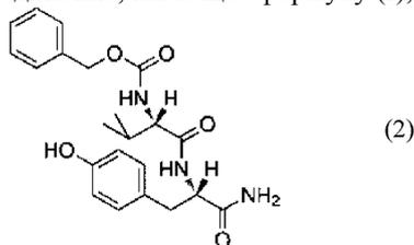
Название этого соединения "бензил (1S)-1-[[[(1S)-2-амино-1-(4-гидроксифенил)-2-оксоэтил]амино]карбонил]-2-метилпропилкарбамаат", доступен от SIGMA S776688.
