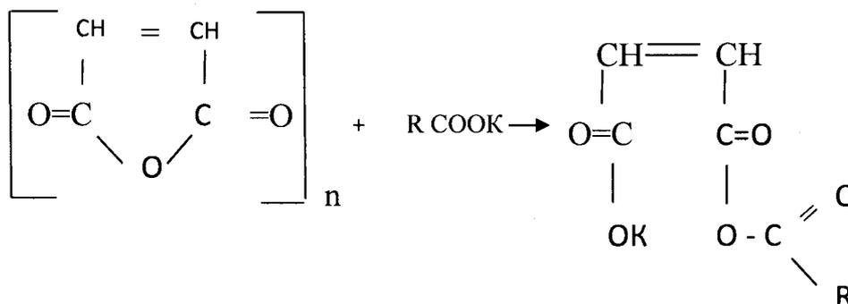
образуя сложный поликарбоксилатный полимер с более разветвленной полимерной цепью, оказывающей армирующее действие на формирующуюся структуру бетона на молекулярном уровне, обеспечивая повышение прочности на растяжение при изгибе твердеющего бетона в раннем возрасте.
