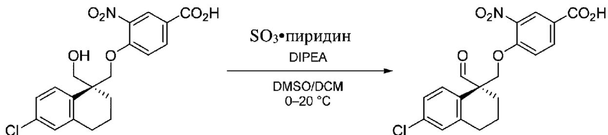
[62] **(R)-4-((6-хлор-1-формил-1,2,3,4-тетрагидронафталин-1-ил)метокси)-3-нитробензойная кислота**. Реактор EasyMax объемом 100 мл, оснащенный верхнеприводной мешалкой, датчиком температуры и впускным отверстием для N<sub>2</sub>, заполняли соединением Y1, где R<sup>1</sup> представляет собой CO<sub>2</sub>H, (1,85 г, 4,72 ммоль, 1,00 экв.) и DCM (9,25 мл, 5,0 об.). К этой взвеси добавляли N, N-диизопропилэтиламин (3,05
