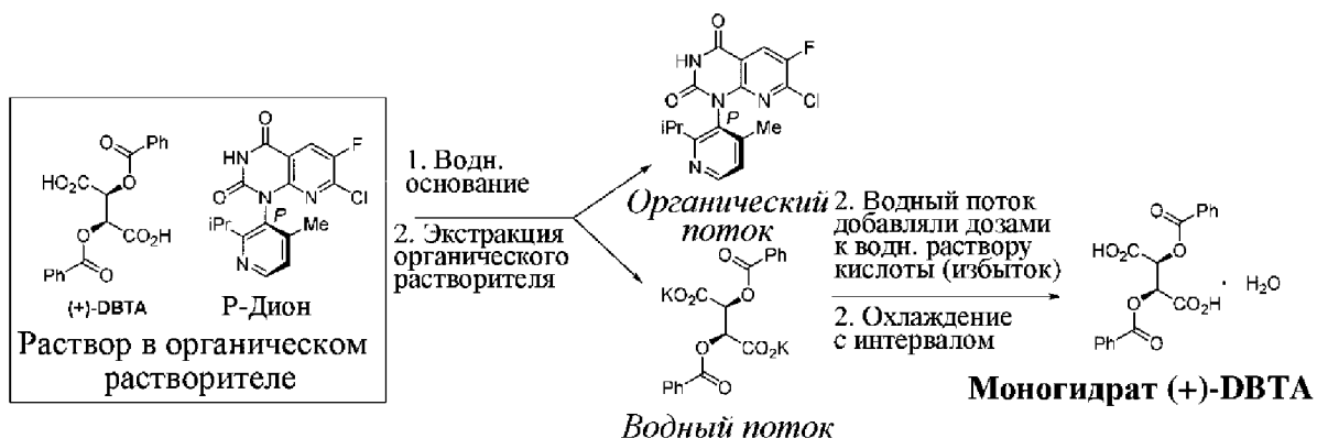
Схема 2. Выделение моногидрата (+)-ДВТА
