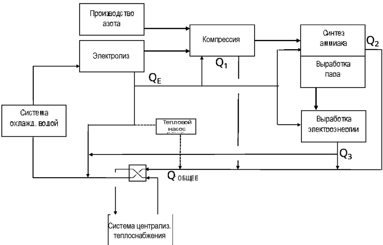
Фиг. 1 Модернизация централизованного теплоснабжения с помощью дополнительного теплового насоса
