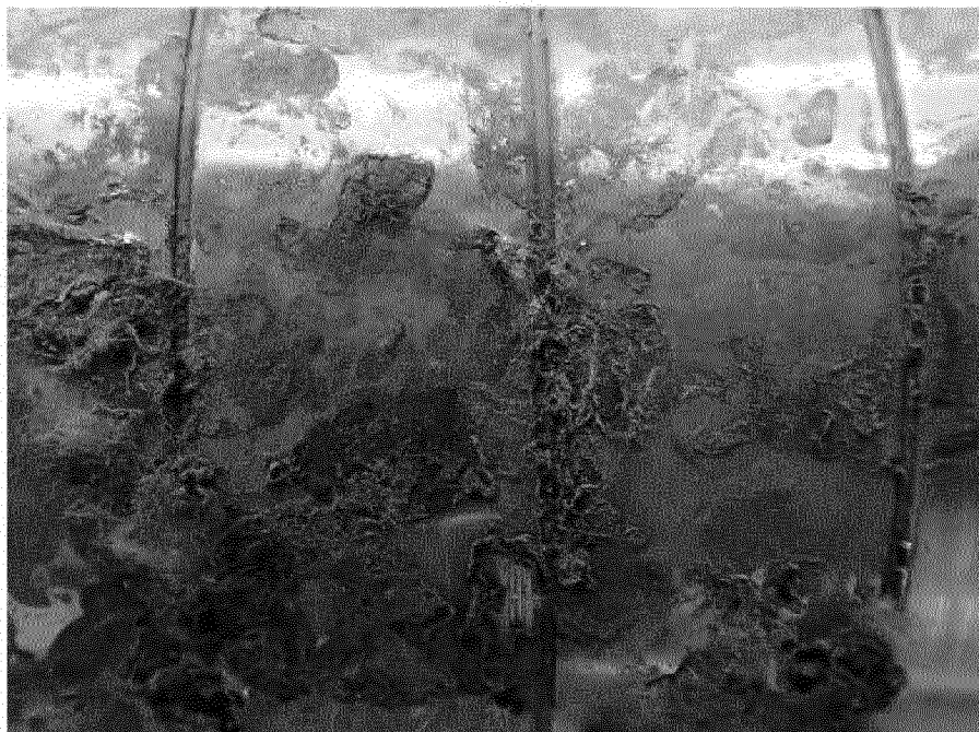
Нижняя сторона пробных образцов в увеличенном масштабе после испытания со стандартным материалом Prorox PS960. Без удаления отложений.
