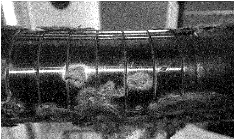
Тест В. Нижняя сторона пробных образцов после 21 цикла испытания В с материалом Prorox PS960 WR-Tech, содержащим ингибитор коррозии. Без удаления отложений.
