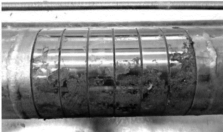
Нижняя сторона пробных образцов после 21 цикла испытания со стандартным материалом Prorox PS960. Без удаления отложений.
