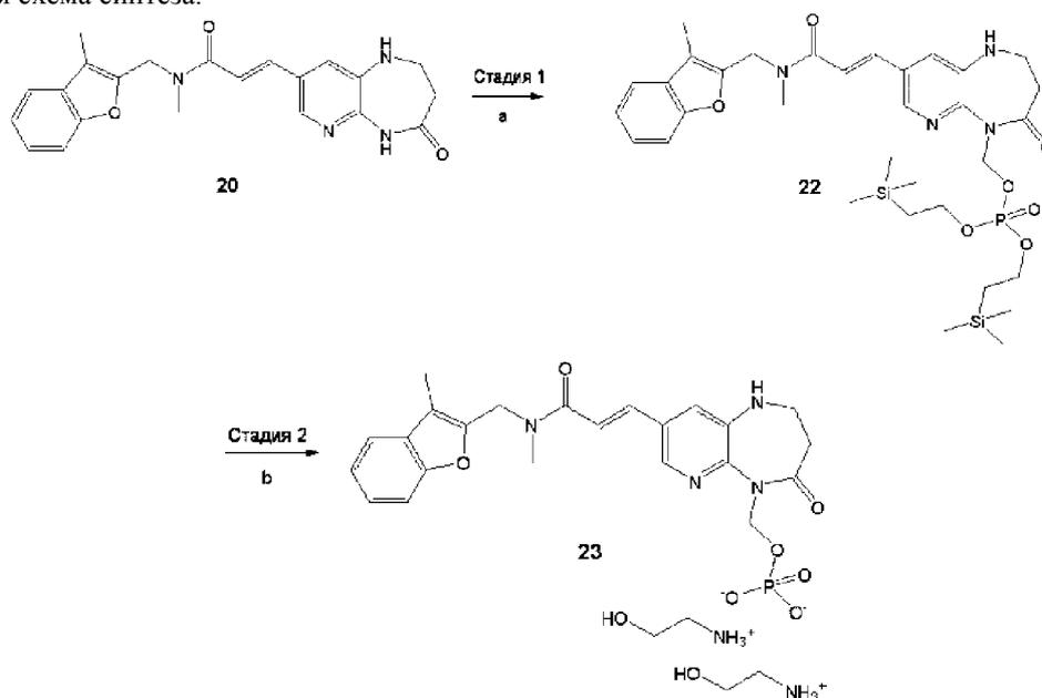
Условия реакции: а) 1) 18-краун-6, NMP/N-этилпирролидон, КТ; 2) t-BuOK при -20°C до -35°C, затем хлорметил бис-[2-(триметилсилил)этил]фосфат 21; б) ТФК/ДХМ, длительная обработка.
