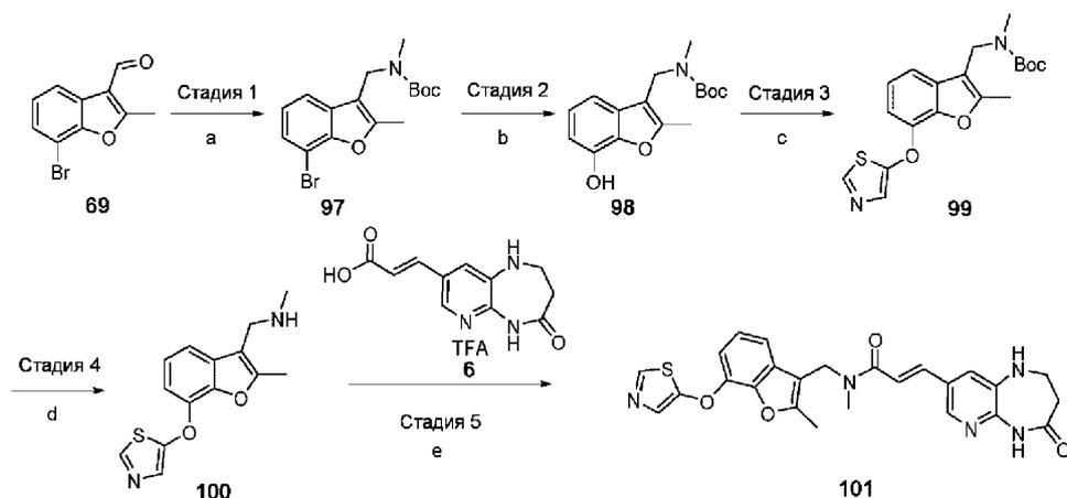
Условия реакции: а) i) NH<sub>2</sub>Me, ТАБН, EtOH; ii) Boc<sub>2</sub>O, ДМАП, ДХМ; б) Pd-175, tBuBrettPhos, KOH, 1,4-диоксан, H<sub>2</sub>O; в) 5-бромтиазол **92**, CuI, N,N-диметилглицин, Cs<sub>2</sub>CO<sub>3</sub>, ДМФ; д) ТФК, ДХМ; е) ГАТУ, ДИПЭА, ДМФ.
