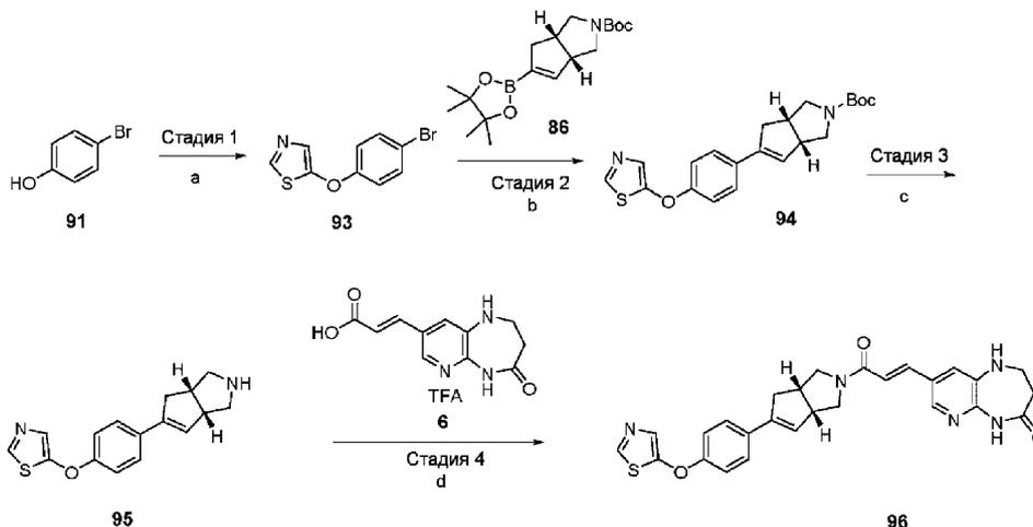
Условия реакции: а) 5-бромтиазол 92,  $\text{Cs}_2\text{CO}_3$ , CuI, ДМФ, 110°C; б)  $\text{Pd}(\text{dppf})\text{Cl}_2$ ,  $\text{K}_2\text{CO}_3$ , 1,4-диоксан, 90°C; в) ТФК, ДХМ; д) ГАТУ, ДИПЭА, ДМФ.
