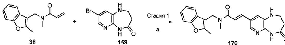
Условия реакции: а) Pd-162,  $\text{NCy}_2\text{NMe}$ ,  $\text{NBu}_4\text{Cl}$ , 1,4-диоксан, 80°C 8-бром-1,2,3,5-тетрагидро-4H-пиридо[2,3-b][1,4]дiazепин-4-он (соединение 169) синтезируют согласно методикам, описанным в литературе, например, AFFINIUM PHARMACEUTICALS, INC: WO2007/67416, 2007, A2 и AURIGENE DISCOVERY TECHNOLOGIES LIMITED; WO2013/80222, 2013, A1.
