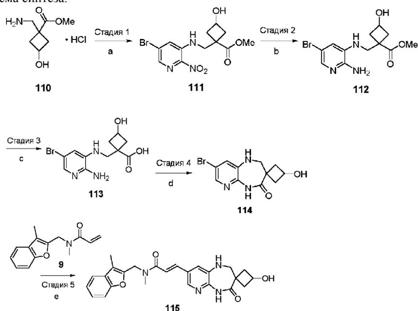
Условия реакции: а) 5-бром-3-фтор-2-нитропиридин 11, ТЭА, EtOH, кипение с обратным холодильником; б) Fe, NH<sub>4</sub>Cl, EtOH, H<sub>2</sub>O, кипение с обратным холодильником; в) LiOH, H<sub>2</sub>O, ТГФ; д) ГАТУ, ДИПЭА, ДМФ; е) Pd-162, MeNCy<sub>2</sub>, NBu<sub>4</sub>Cl, 1,4-диоксан, 80°C.
