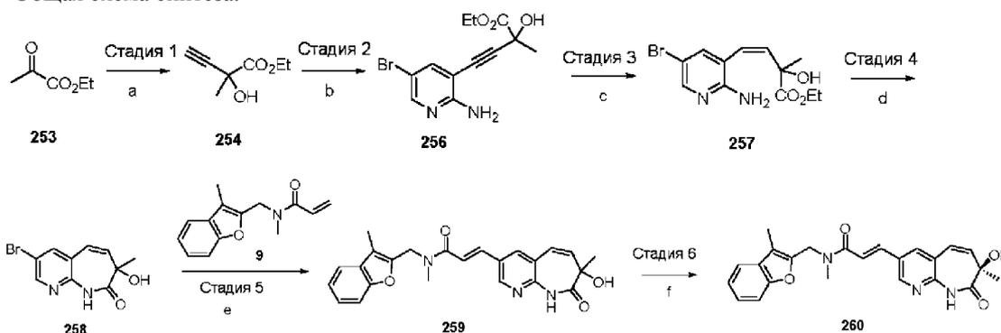
Условия реакции: а) бромид этиланилмагния, -78°C до КТ; б) хлорид бис-(трифенилфосфин)палладия(II), 5-бром-3-йодпиридил-2-амин 255, CuI, ТЭА, ТГФ, 80°C; в) H<sub>2</sub>O, Pd/C, EtOAc; д) NaH, ТГФ, 0°C до КТ; е) Pd-116, ДИПЭА, NBU<sub>4</sub>Cl, 1,4-диоксан, 80°C; ф) хиральное разделение.
