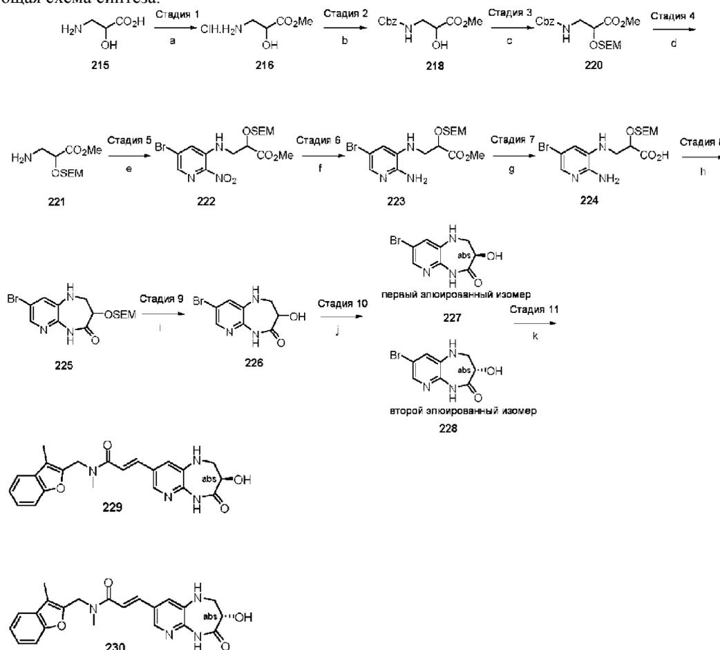
Условия реакции: а) MeOH, SOCl<sub>2</sub>, 0°С до КТ; б) CBZ-Cl 217, ТЭА, ТГФ, 0°С; SEM-Cl 219, ДИПЭА, ДХЭ, 60°С; д) Pd/C, H<sub>2</sub>, 5 бар; е) 5-бром-3-фтор-2-нитропиридин 11, ТЭА, EtOH, кипение с обратным холодильником; ф) Fe, NH<sub>4</sub>Cl, EtOH, H<sub>2</sub>O, кипение с обратным холодильником; г) ГАТУ, ДИПЭА, ДМФ; и) а) ТФК, б) Na<sub>2</sub>CO<sub>3</sub>; ж) Chiralpak IA колонка (25% ацетонитрил:75% воды); з) 9, Pd-116, ДИПЭА, NBu<sub>4</sub>Cl, 1,4-диоксан, 80°С.
