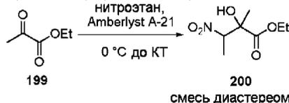
Стадия 1. Этил 2-гидрокси-2-метил-3-нитробутаноат (соединение 200).
