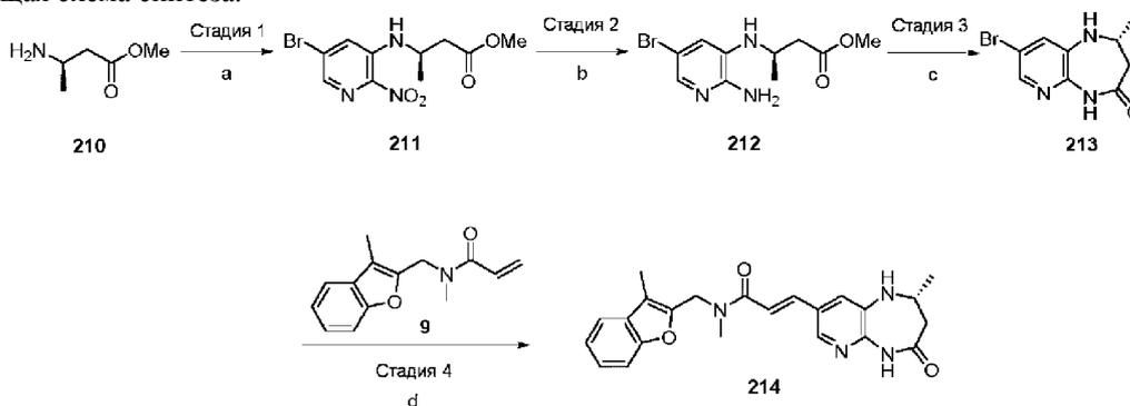
Условия реакции: а) 5-бром-3-фтор-2-нитропиридин 11, ТЭА, EtOH, 80°C; б) Fe, NH<sub>4</sub>Cl, EtOH, вода, 90°C; в) NaH, ТГФ, 0°C до КТ; д) Pd-116, NBu<sub>4</sub>Cl, ДИПЭА, 1,4-диоксан, 80°C.
