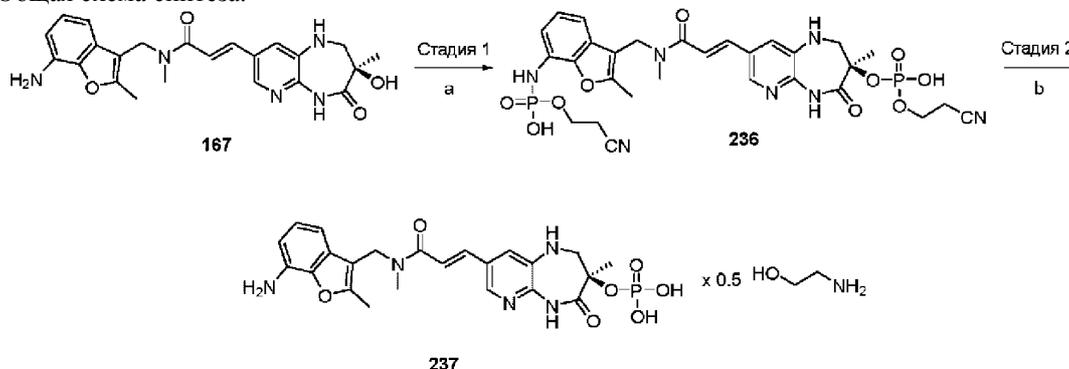
Условия реакции: а) i) бис-(2-цианоэтил)диизопропилфосфорамидит, 1H-тетразол, 1 день, КТ; ii) 0,1 М раствор йода (вода/2,6-лутидин/ТГФ, 1/19/80) при 0°C, 20% об./об. Na<sub>2</sub>S<sub>2</sub>O<sub>3</sub>; б) i) BSTFA, АЦН, основание Бартона, 35 мин при 0°C, затем HCOOH; ii) вода, HOCH<sub>2</sub>CH<sub>2</sub>NH<sub>2</sub> (5,0 экв.)
