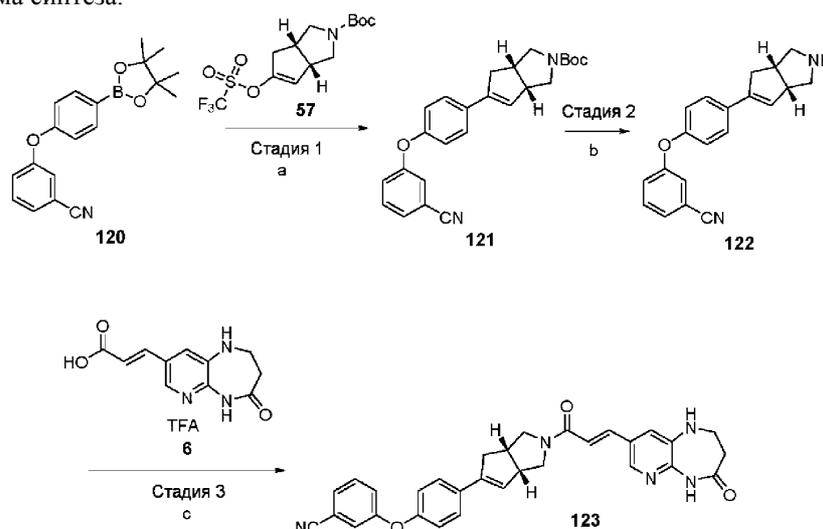
Условия реакции: а) K<sub>2</sub>CO<sub>3</sub>, H<sub>2</sub>O, PdCl<sub>2</sub>(dppf), 1,4-диоксан, 80°C; б) ТФК, ДХМ; в) ГАТУ, ДИПЭА, ДМФ.
