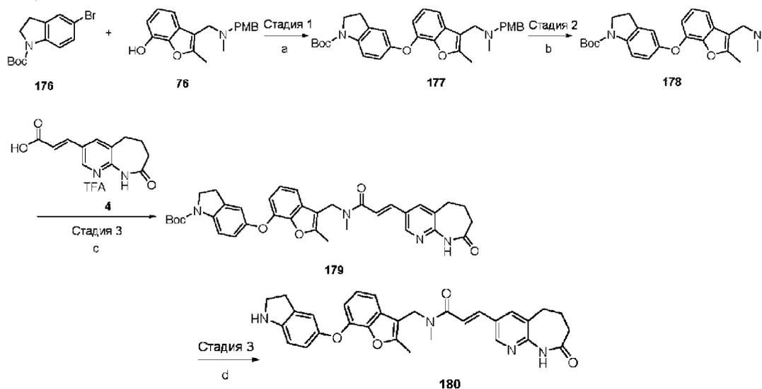
Условия реакции: а) CuI, N,N-диметилглицин, Cs<sub>2</sub>CO<sub>3</sub>, ДМФ, 100°C; б) Pd/C, MeOH, H<sub>2</sub>, 50°C; в) ГАТУ, ДИПЭА, ДМФ; д) ТФК, ДХМ.
