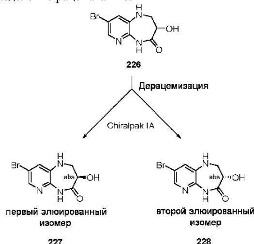
Энантиомеры разделяют хиральной преп. ВЭЖХ с применением колонки Chiralpak® IA (Daicel Ltd.) (2×25 см), скорость потока 13,5 мл мин<sup>-1</sup>, элюируя смесью 25% ацетонитрил:75% вода, УФ-
