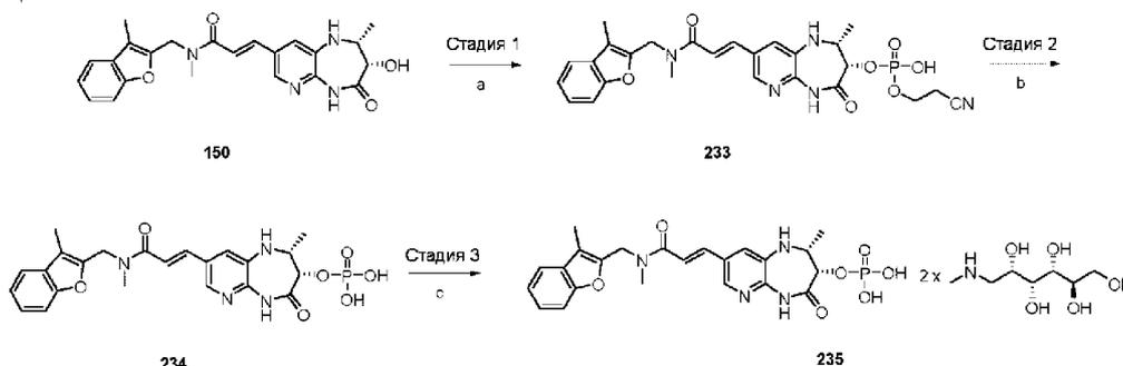
Условия реакции: а) i) бис-(2-цианоэтил)диизопропилфосфорамидит, 1Н-тетразол, 1 день, КТ; ii) 0,1 М раствор йода (вода/2,6-лутидин/ТГФ, 1/19/80) при 0°C, 20% об./об. Na<sub>2</sub>S<sub>2</sub>O<sub>3</sub>; б) BSTFA, АЦН, 2-трет-бутил-1,1,3,3-тетраметилгуанидин, 35 мин при 0°C, затем НСООН; в) Н<sub>2</sub>O и MeCN (60 мл, 1/1), меглумин 2 экв.
