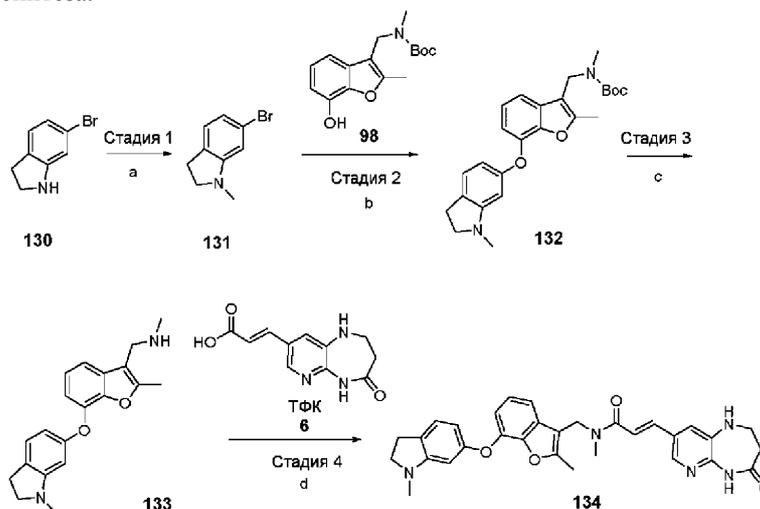
Условия реакции: а) NaH, MeI, ТГФ, 0°C; б) CuI, N,N-диметилглицин, Cs<sub>2</sub>CO<sub>3</sub>, ДМФ, 110°C; в) ТФК, ДХМ; д) ГАТУ, ДИПЭА, ДМФ.
