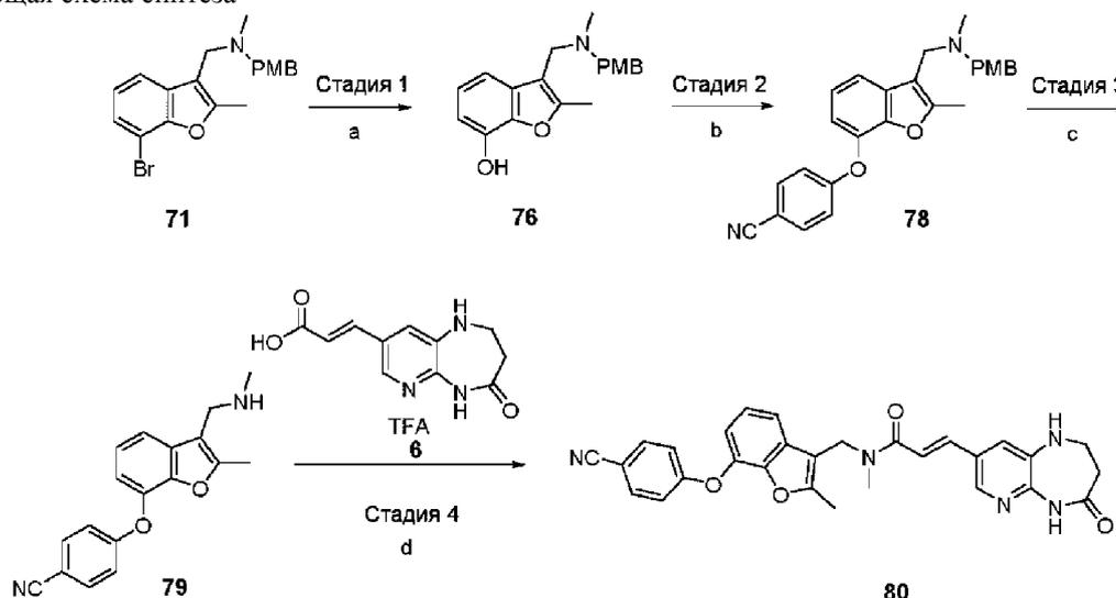
Условия реакции: а) Pd-175, tBuBrettPhos, KOH, H<sub>2</sub>O, диоксан, 80°C; б) 4-фторбензонитрил 77, K<sub>2</sub>CO<sub>3</sub>, NMP, 100°C; в) 1-хлорэтил хлорформат, ДХМ, 0°C до КТ; д) ГАТУ, ДИПЭА, ДМФ.
