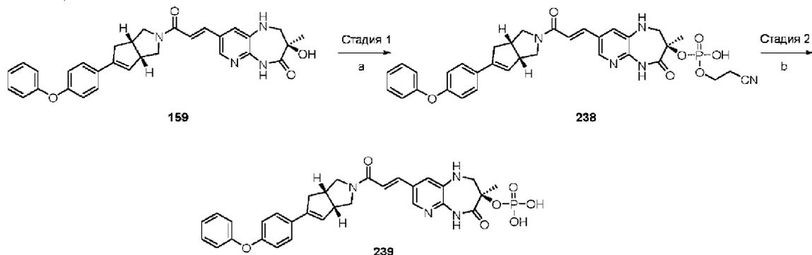
Условия реакции: а) i) бис-(2-цианоэтил)диизопропилфосфорамидит, 1Н-тетразол, 1 день, КТ; ii) 0,1 М раствор йода (вода/2,6-лутидин/ТГФ, 1/19/80) при 0°С, 20% об./об. Na<sub>2</sub>S<sub>2</sub>O<sub>3</sub>; б) BSTFA, АЦН, основание Бартона, 35 мин при 0°С, затем НСООН.
