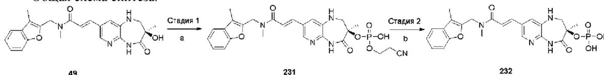
Условия реакции: а) i) бис-(2-цианоэтил)диизопропилфосфорамидит, 1Н-тетразол, 1 день, КТ; ii) 0,1 М раствор йода (вода/2,6-лутидин/ТГФ, 1/19/80) при 0°C, 20% об./об. Na<sub>2</sub>S<sub>2</sub>O<sub>3</sub>; б) BSTFA, АЦН, основание Бартона, 35 мин при 0°C, затем НСООН.
