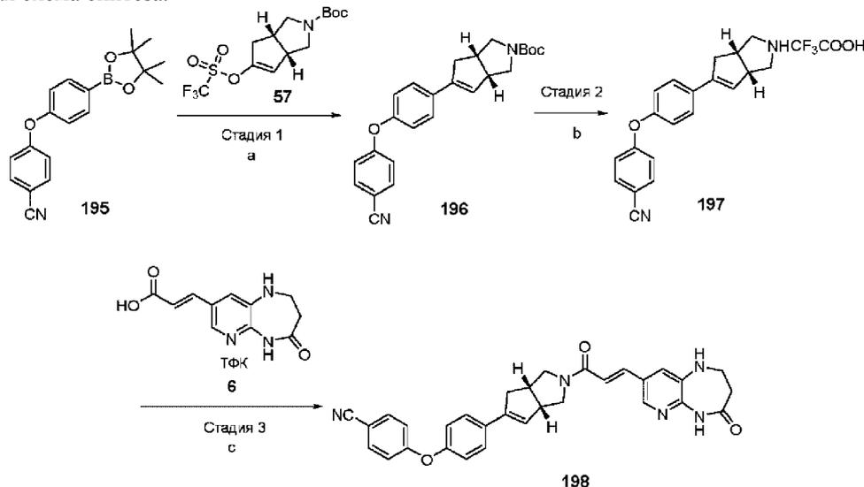
Условия реакции: а)  $K_2CO_3$ ,  $H_2O$ ,  $PdCl_2(dppf)$ , 1,4-диоксан,  $80^\circ C$ ; б) ТФК, ДХМ; в) ГАТУ, ДИПЭА, ДМФ.
