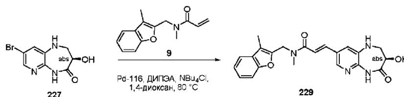
Стадия 11а. (R,E)-3-(3-Гидрокси-4-оксо-2,3,4,5-тетрагидро-1H-пиридо[2,3-b][1,4]дiazепин-8-ил)-N-метил-N-((3-метилбензофуран-2-ил)метил)акриламид (соединение 229).
