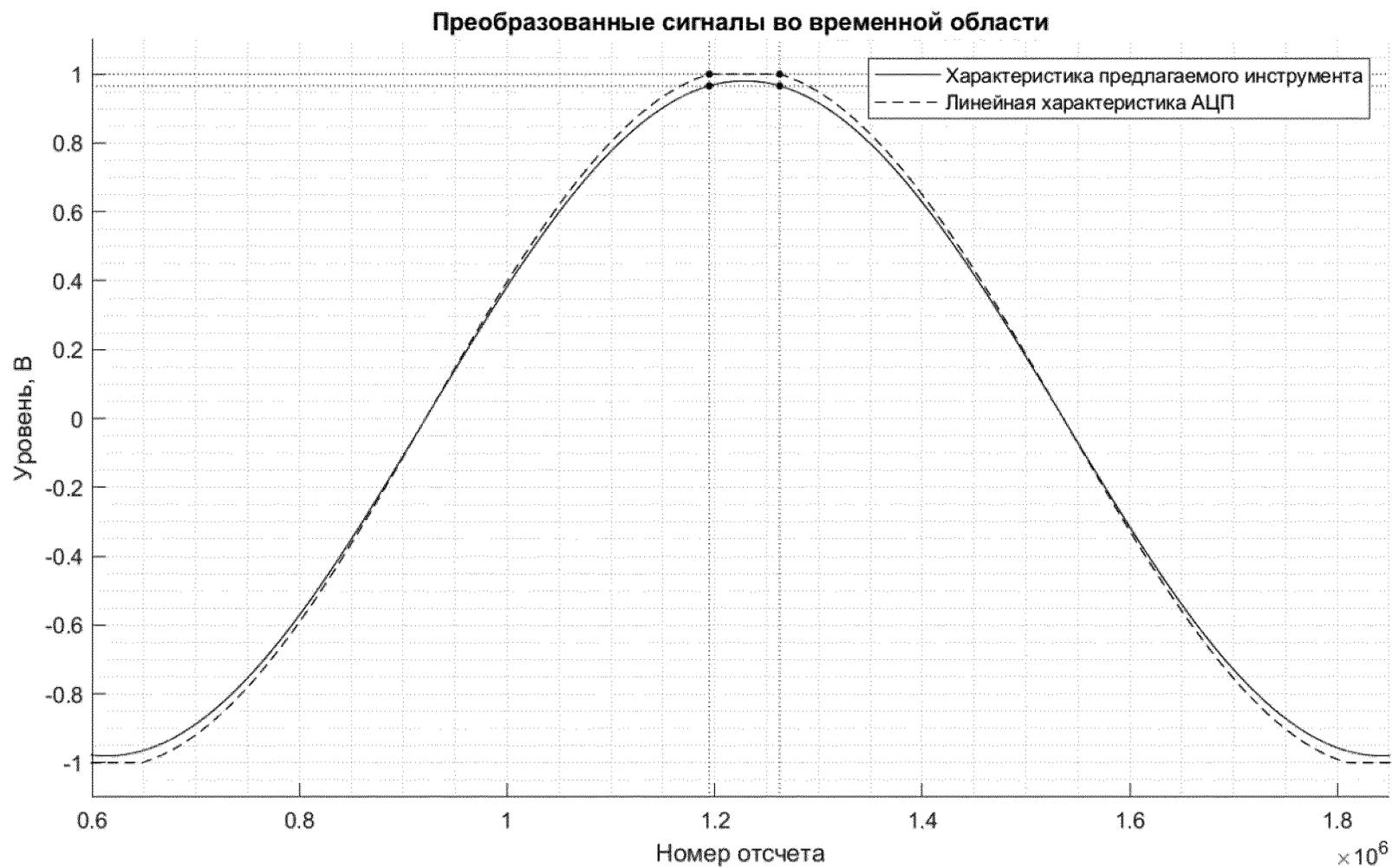
Фиг. 9. Разная амплитуда сигнала, но одинаковые углы ограничения.
