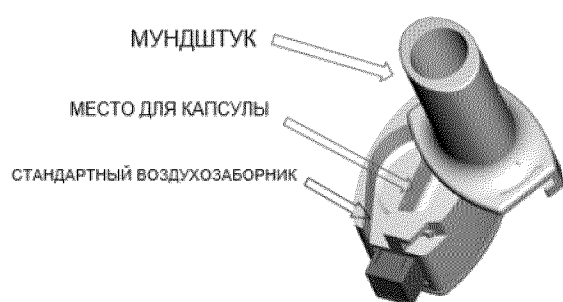
Фиг. 1b: капсульный ингалятор однократной дозы
